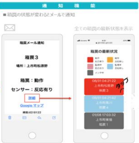
箱罾の開閉状態と焦電型赤外線センサー検知結果を把握 上記の状態変化に応じてメール送信 箱罾一覧で箱罾の状態を把握
