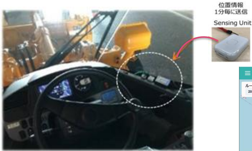
除雪車に位置情報検出Sensing Unitを設置
